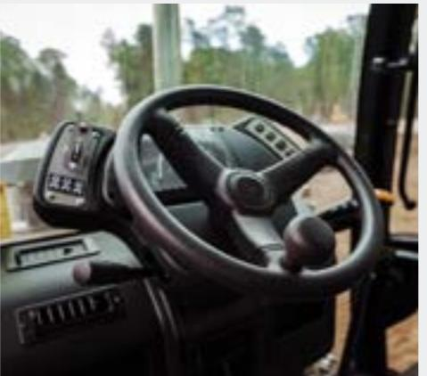
Рулевая колонка регулируется по углу наклона. Удобное рулевое колесо не требует приложения значительных усилий при маневрировании. Имеет рукоятку для облегчения управления одной рукой.
