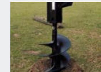
Доступны со смещенной опорой. Диаметр бура от 150 мм до 900 мм. Максимальный расход в гидросистеме 95 л/мин (для обеих моделей).
