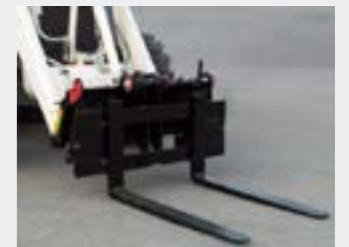
Безопасная рабочая нагрузка при 500 мм. Центр нагрузки 2500 кг. Класс 2В 100 мм x 40 мм. Вес 228 кг.
